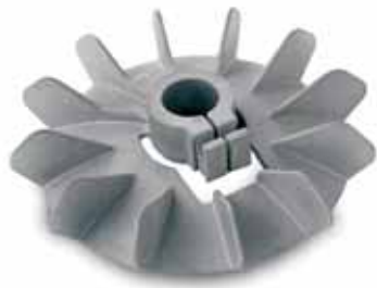
Flügelrad | EN AC-AISI7Mg Dm 160 x 33 mm | 0,2 kg
